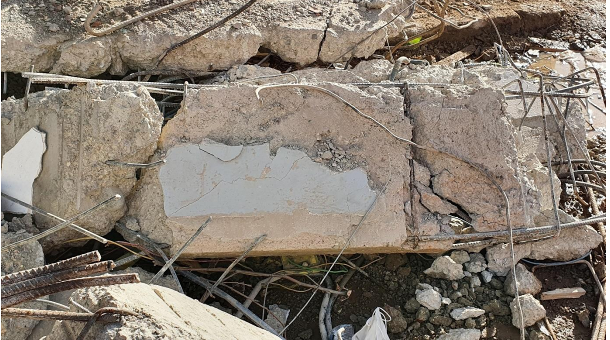
Fotoğraf 4. Bayraklı, Doğanlar Apartmanından çıkarılan betonarme kirişteki asal donatılar, yanıl donatılar ve betonun durumu.
