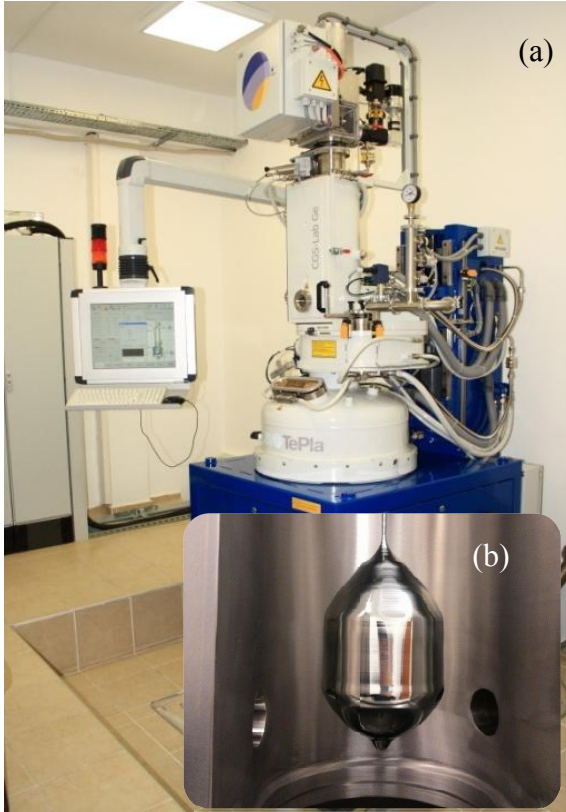
Şekil 1: (a) Gazi Üniversitesi Fotonik Uygulama ve Araştırma Merkezi'nde bulunan CGS-Lab Ge sistemi ve (b) büyütülen n-Ge tek kristali.
