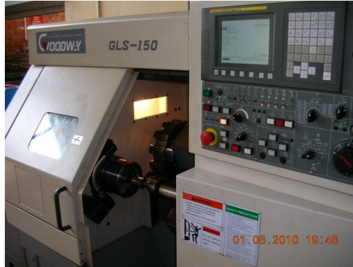
Şekil 3. İşlenebilirlik testlerinin yapıldığı CNC torna tezgâhı.
