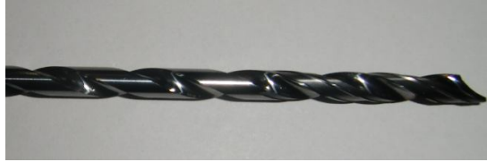
Şekil 8. Deneysel çalışma 1 - Matkap kırılması
