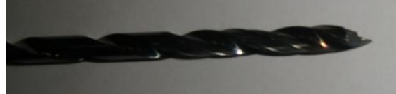
Şekil 9. Deneysel çalışma 2 -Matkap kırılması
