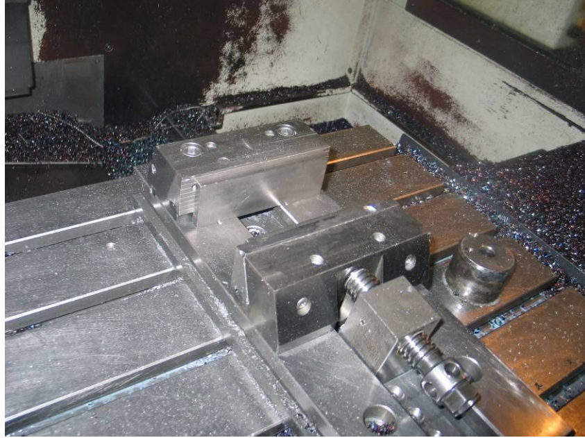
Şekil 4: Deneylerde kullanılan sabit altlık ve mengene
