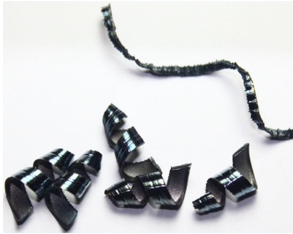
Şekil 9. İşlemin ilk anında (uzun talaş) ve sonrasında elde edilen talaşlar (kısa-kırılmış talaşlar)
