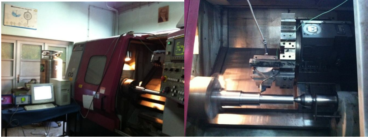
(a) (b) Şekil 2. Deney tertibatı görünümü (a) CNC torna tezgahı ve (b) iş parçası ve takım
