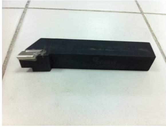
Şekil 1. Kesici ucu yapıştırma-yumuşak lehimli bağlanmış, deneylerde kullanılan kesici takım.
