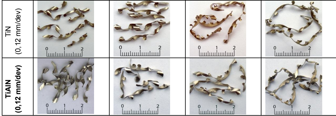
Şekil 3. 0,12 mm/dev ilerlemede artan kesme hızı ile talaş formlarındaki değişim
